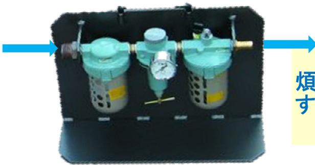
煩わしいエアーツールへのオイル補給を自動ですることにより作業時間の短縮できます。
