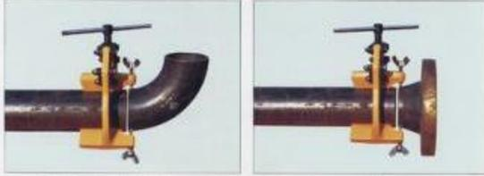
従来の芯出し機では、固定の位置でしかエルボ・フランジ・レデューサー等ストレート部の芯出しができません。特許の「調整型」の機構で、簡単に芯出しを行なえます。
